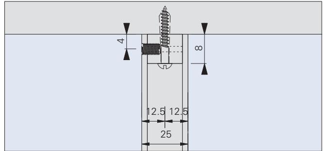
Verbindungsklotz als Deckenanschluss
