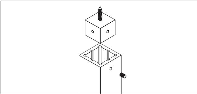
25.505 Verbindungsklotz für Decken- und Wandanschluss in Kombination mit Profil 25.500
